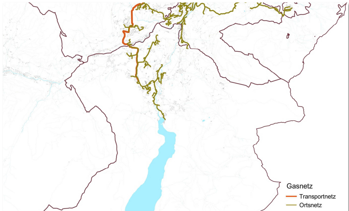
Abbildung 2: Netzinfrastruktur Gas (Transport- und Ortsnetz)
